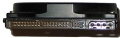
Conexiones de un disco duro IDE. De izquierda a derecha: conector para el cable IDE, jumpers y conector para la alimentación eléctrica
